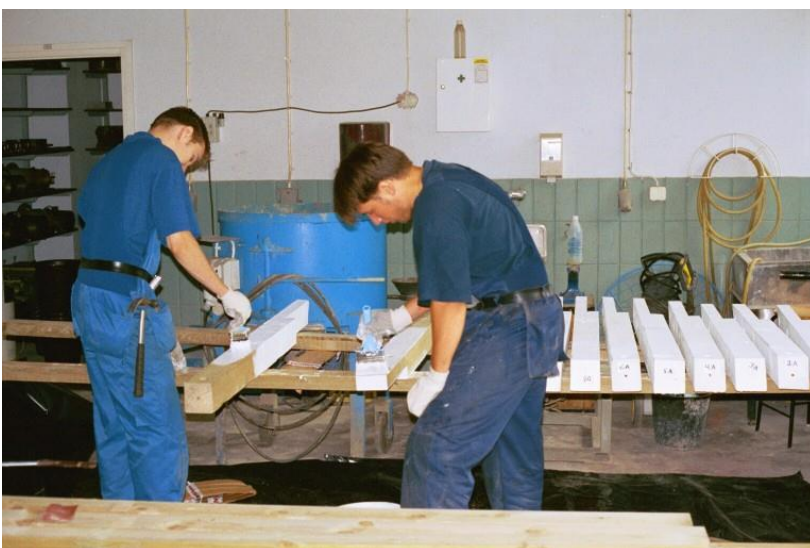
Bild 127. Bottenfärg på broräcken stryks på i laboratoriet i TAMK. (TAMK)
